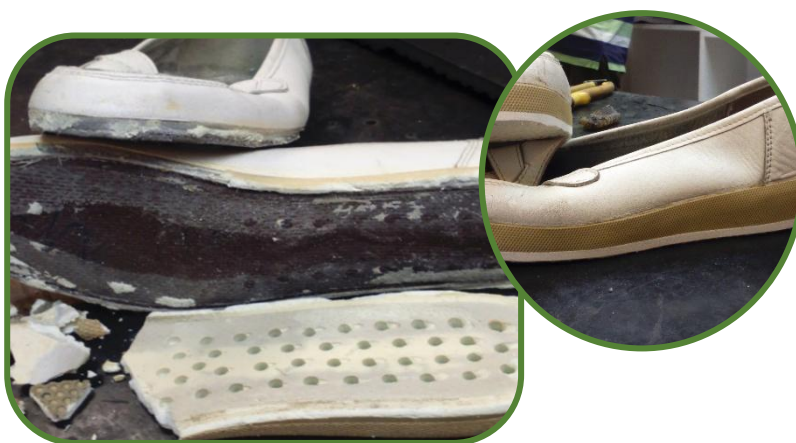
Szétbontott, elporlott kényelmi női cipő teljes talpcseréje
